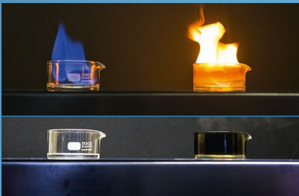
Brennvergleich Diesel (rechts) und rußarmer, CO 2 -neutral hergestellter Kraftstoff Oxymethylenether OME (links)
